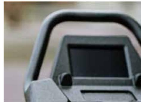
I manubri sono progettati con più posizioni per le mani per adattarsi a posture e stili di guida diversi. È una parte in alluminio pressofuso con rivestimento in poliurea per una buona presa e isolamento.
