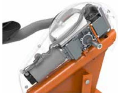
L'innovativo motore elettrico autoalimentato e gli ingranaggi forniscono un volano virtuale per offrire un'esperienza reale sul ciclo della strada. La resistenza funziona come azionamento automatico e si adatta automaticamente. Gli utenti possono sovrascrivere manualmente l'unità automatica modificando la resistenza in 10 passaggi (45-750 Watt) tramite l'app o lo schermo.
