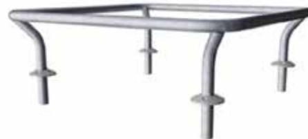
I corrimani intesi come impugnature durante gli esercizi sono realizzati in acciaio zincato a caldo da 38 mm, un grande diametro per una buona presa e per sostenere il polso. L'altezza del corrimano è 940 mm dalla parte superiore della piastra HPL. La distanza tra le rotaie è di 900 mm.
