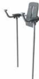
Il telaio del piedino è realizzato in tubo d'acciaio HDG Ø38 x 2 mm. Le piastre di supporto sono realizzate in Ekogrip® da 15 mm, una piastra in PE da 15 mm con uno strato superiore di 3 mm di gomma termoplastica con effetto antiscivolo. I supporti del braccio sono 110 x 195 mm, 580 mm di distanza e 1315 mm dal suolo. Lo schienale è di 335 x 500 mm. L'apertura nella parte posteriore è di 30 x 350 mm.
