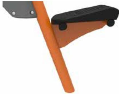
Il sedile è realizzato in gomma poliuretanica e ha una piastra di inserimento in acciaio che lo collega al telaio in acciaio. Il sedile è posizionato sotto un angolo di 12 gradi, in grado di accogliere altezze di seduta da 550 a 620 millimetri.
