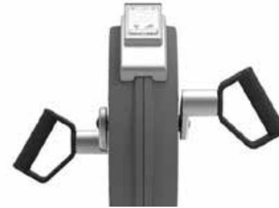
Il fattore Q della bici da braccio è di 175 mm, la pedivella è in acciaio inossidabile da 18 mm e collega i bracci del pedale che sono parti in acciaio inossidabile fuso (grado 304). La lunghezza dei bracci del pedale è di 170 mm e i pedali sono collegati con raccordi standard per bici.
