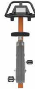
Il fattore Q della bici è di 175 mm, la pedivella è in acciaio inossidabile 18 mm e collega i bracci del pedale che sono parti in acciaio inossidabile fuso (grado 304). La lunghezza dei bracci del pedale è di 170 mm e i pedali sono collegati con raccordi standard per bici.
