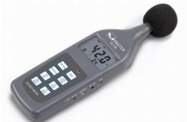
I **fonometri** elettronici sono utilizzati per misurare i livelli di rumore e tengono conto delle variazioni del volume percepito. I filtri di frequenza inseriti nei misuratori hanno proprio lo scopo di bilanciare il dato misurato con la sensibilità dell'orecchio umano e, di conseguenza, stimare la rumorosità dei vari suoni percepiti.
